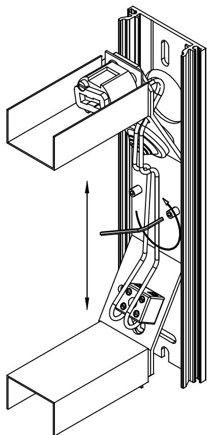
**N.** Steek de voedingskabel door het voedingsgat en bevestig de wandplaat tegen de wand. Draai de stelschroeven van de montageplaat terug vast.
