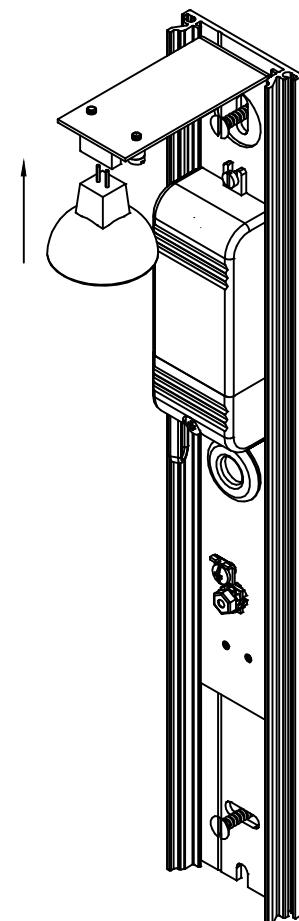
**N**-Plaats de armatuur terug op het wandprofiel en draai de 4 schroeven(A) onderaan en bovenaan de armatuur vast
