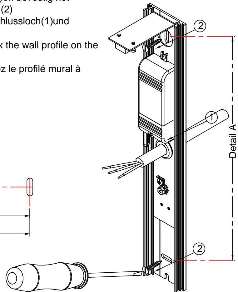
**N**-Sluit de bedrading aan op de Transfo van het wandprofiel
